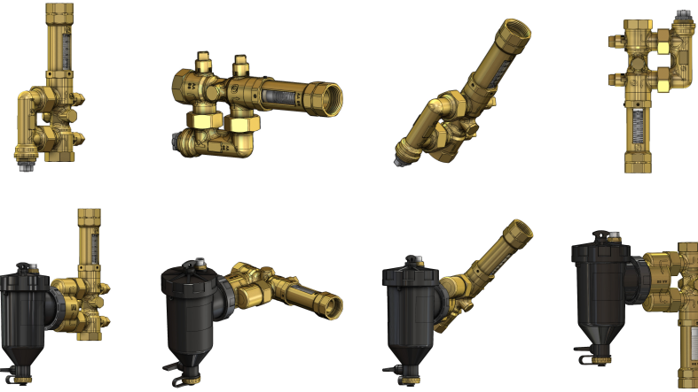
Рис. 9. Допустимые монтажные положения комплекта сервисной арматуры для тепловых насосов AHS
