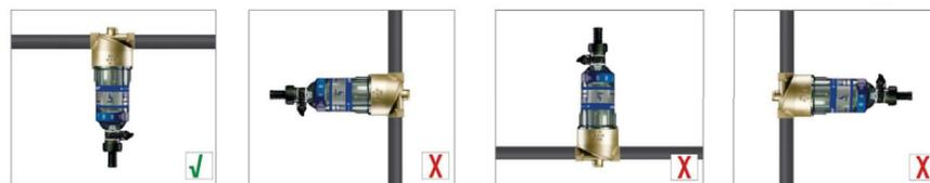
Рис. 5. Допустимое монтажное положение фильтров AWF
