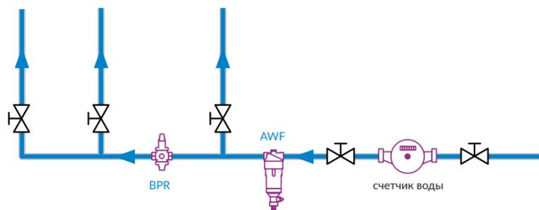
Рис. 7. Пример схемы монтажа фильтра AWF
