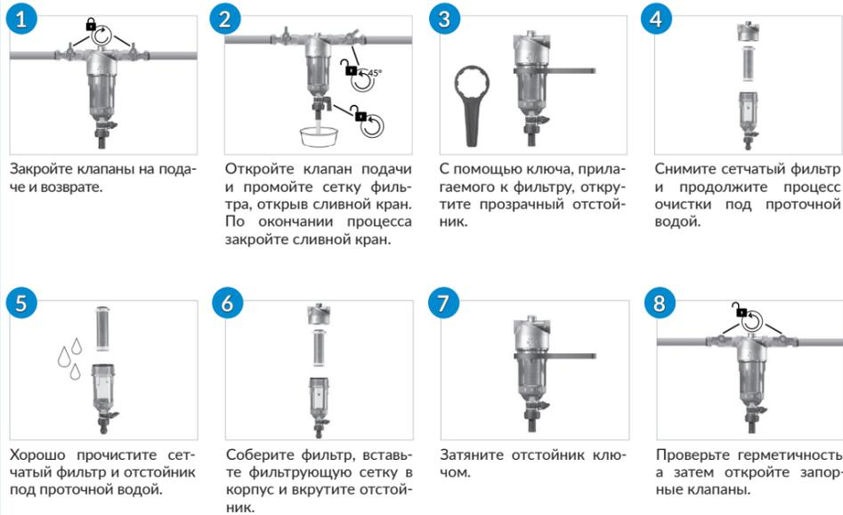
Хорошо прочистите сетчатый фильтр и отстойник под проточной водой.
